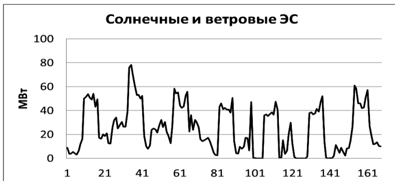
Рис. 1. Суммарная выработка электроэнергии на СФЭС и ВЭС, для 32-ой недели 2030 г.
