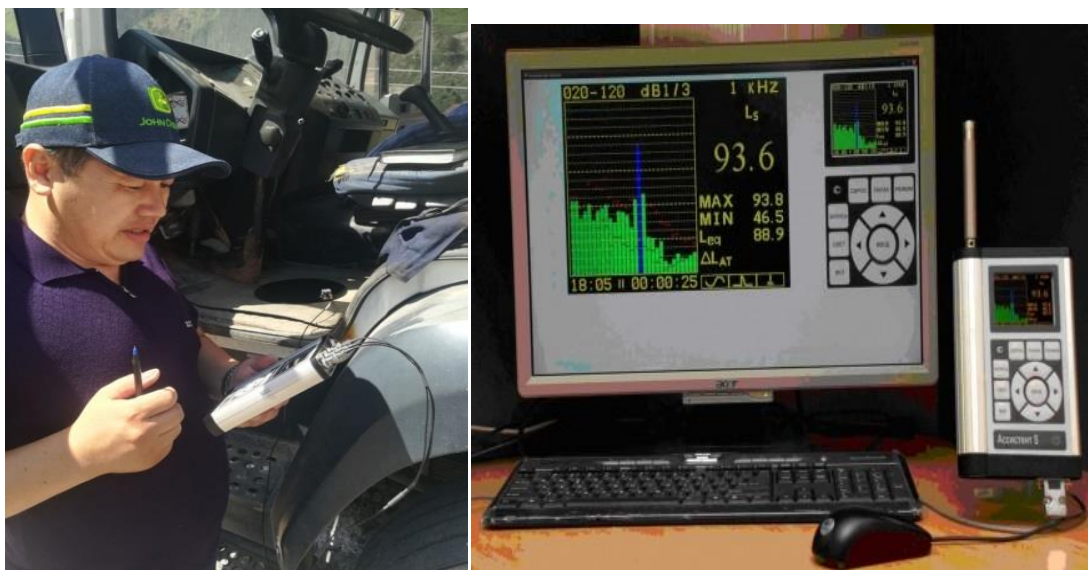
Рис. 2. Процесс измерения шума, вибрации и обработка результатов с помощью компьютера
