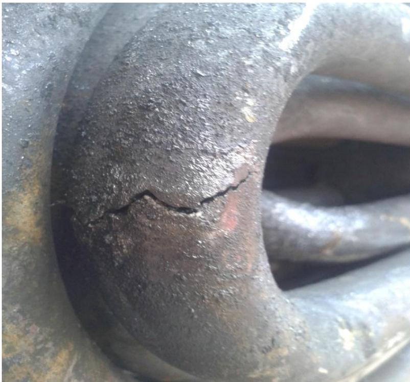
*Рис. 2. Характерный вид разрушений трубок, непосредственно в составе трубного пучка*
