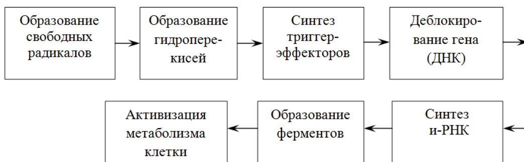
Рис. 1. Схема протекания биохимических процессов при стимулировании биоактивности семян в электрическом поле
