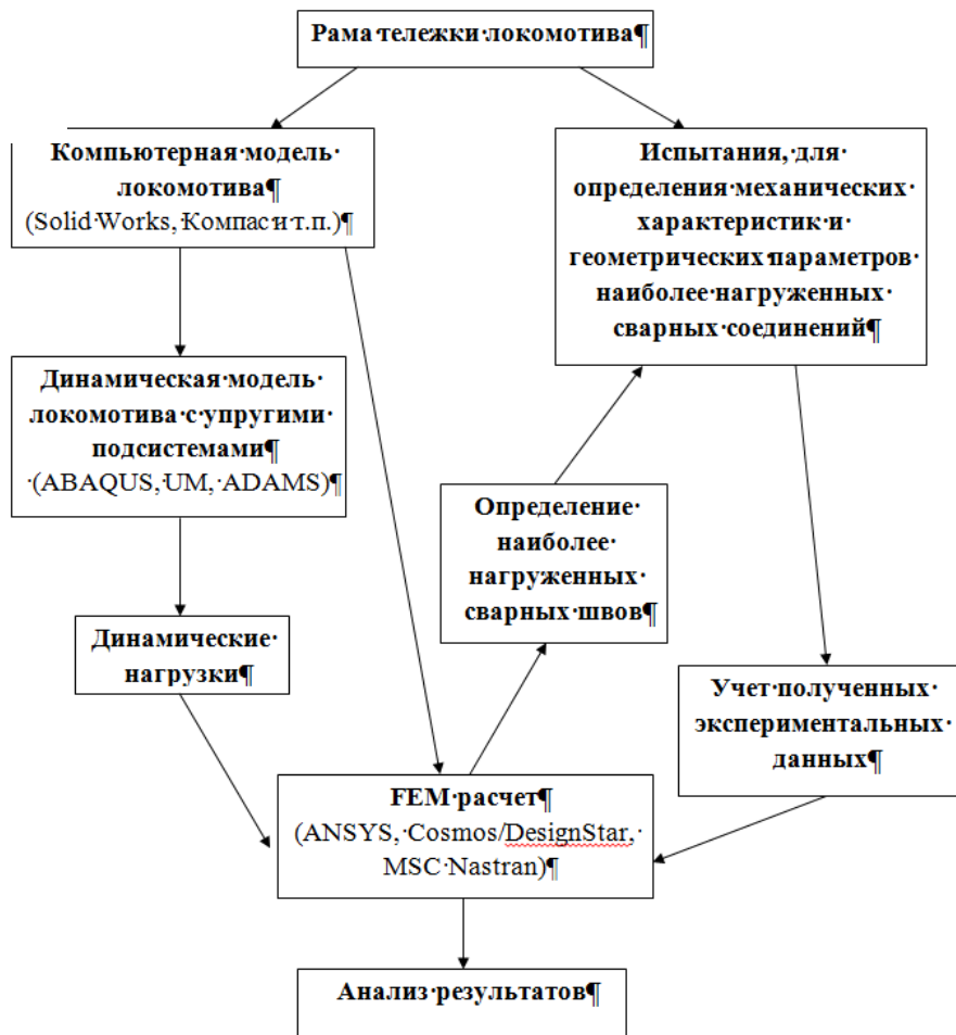
Рис. 1. Структурная схема поэтапной методики расчета нагрузок, возникающих в зоне сварного соединения
