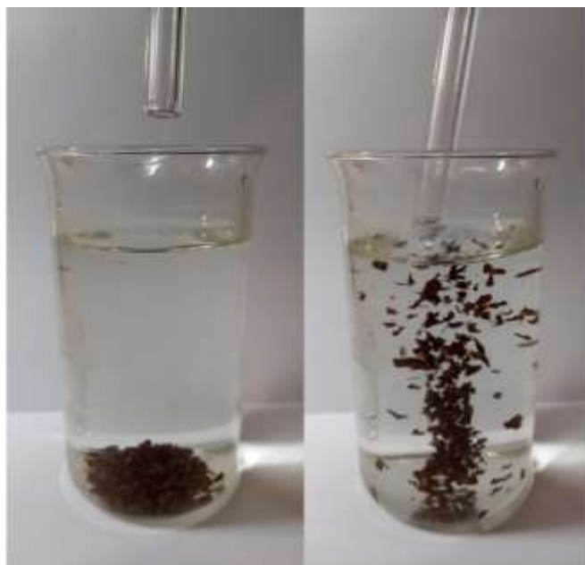
Рис. 5. Вихревое движение частиц тяжелее воды при ее вращении в стеклянном стакане.
