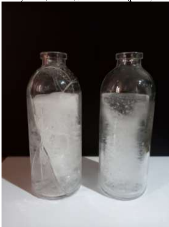
Рис. 1. Отливки из льда, затвердевшие в морозильной камере при 253 К: левая – без теплоизоляции верхней части бутылки с водой; правая – с теплоизоляцией верхней части бутылки с водой.
