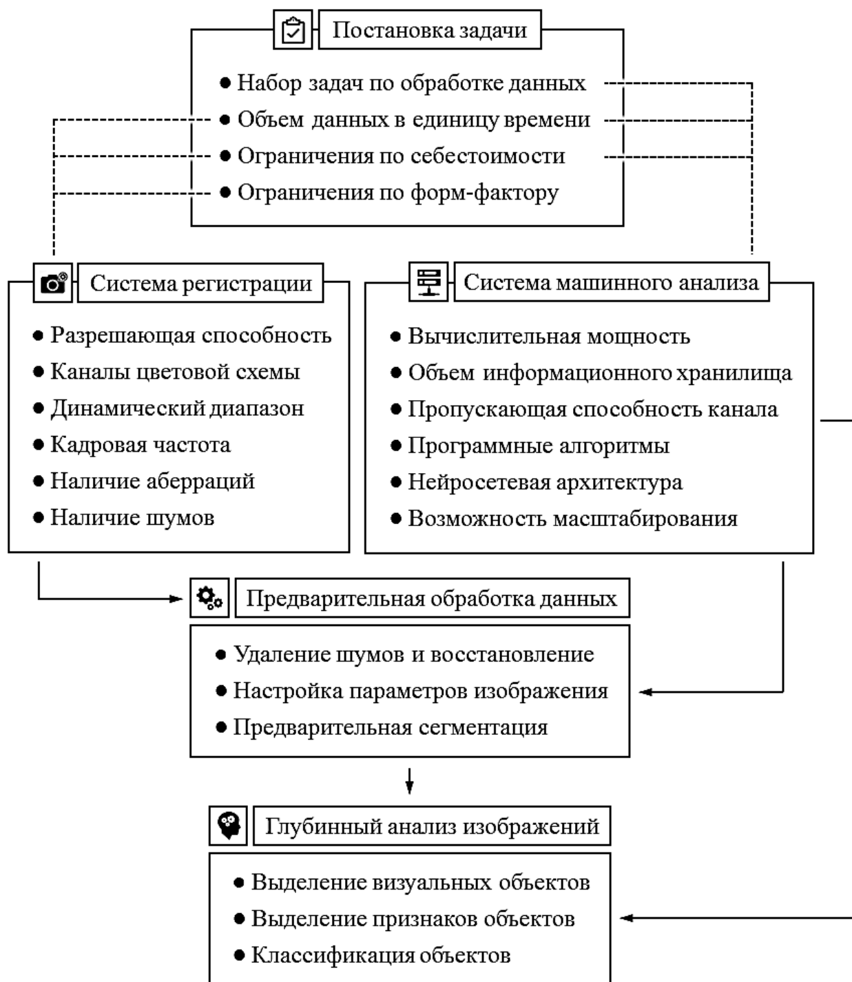
Рис. 1. Базовая схема организации системы машинного анализа массивов графических данных.
