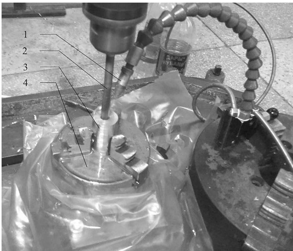
*Рис. 1. Общая схема измерительной установки: 1 – устройство минимизированной подачи смазки, 2 – сверло, 3 – заготовка, 4 – патрон, закрепленный на многокомпонентном динамометре М30-3-6К*
