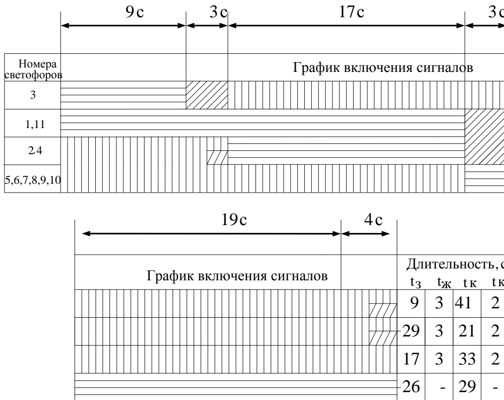
Рис. 5. График режима светофорной сигнализации на пересечении пр-та Победа Революции – ул. Шевченко
