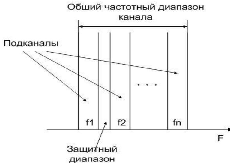
Рис. 1. Разделение частотного диапазона FDMA
