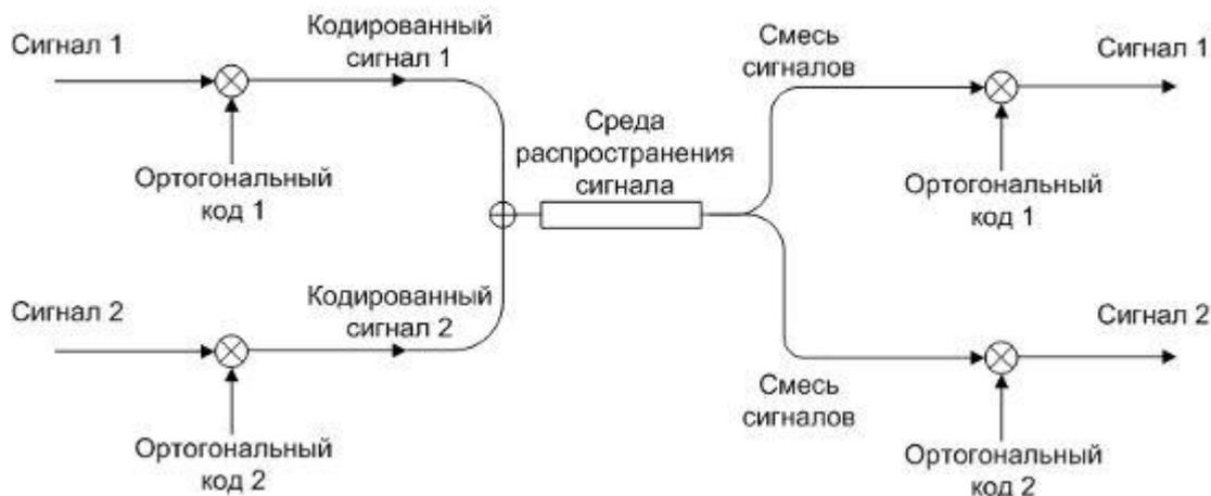
Рис. 3. Структурная схема CDMA
