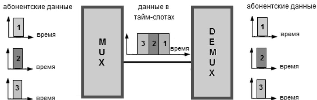
Рис. 2. Структурная схема TDMA
