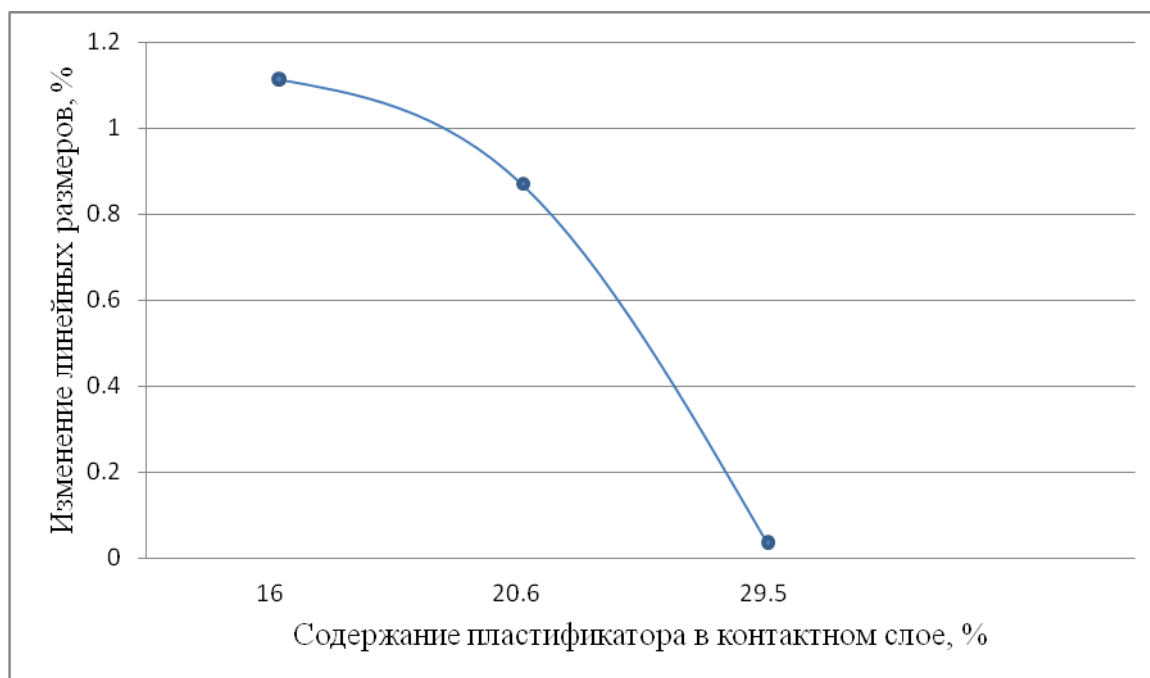
Рис. 1. Зависимость изменения линейных размеров образцов ПВХ-линолеумов от содержания пластификатора в контактном слое (обозначения как в табл. 1)
