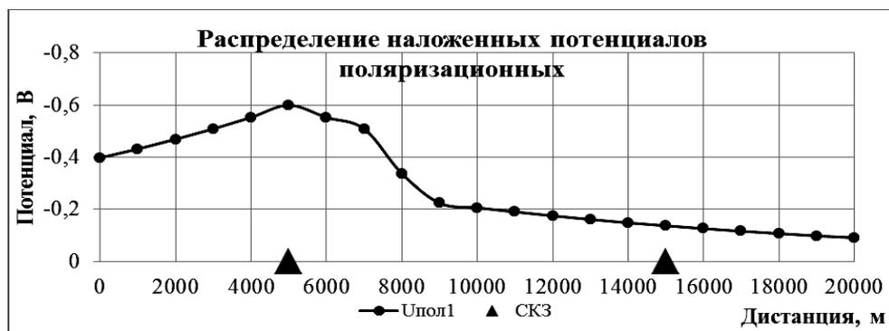
Рис. 1. Распределение поляризационной составляющей  $\Delta U_{\text{пол}}$  вдоль трубопровода
